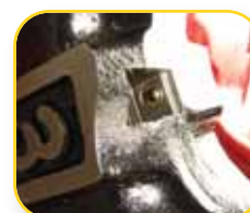
Шарик-фиксатор для легкой и быстрой смены.
