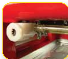
Привод масляного насоса с самозапуском. Регулировка маслоподдачи.
